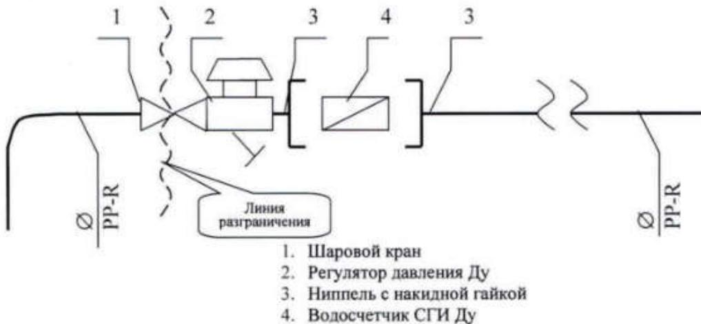
Исполнитель несет ответственность за надлежащее состояние и работоспособность систем горячего и холодного водоснабжения согласно нижеуказанной схеме до волнистой линии слева (включая шаровой кран).
